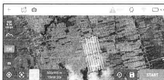
ภาพที่ 4 การวางแผนการบินด้วย Pix4D capture
