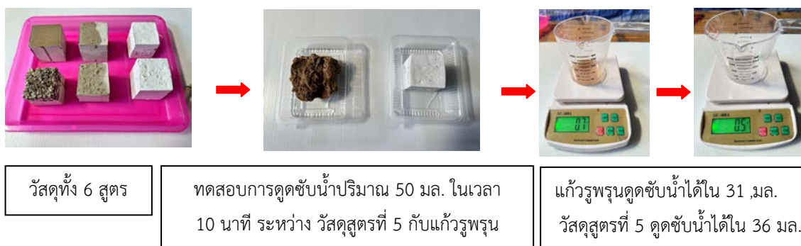
ภาพที่ 2 แสดงกระบวนการทดลองการผลิตวัสดุจากเศษกระเจกเหลือใช้
