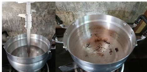
(ก) ภาพก่อนและหลังการทดลองของ หม้อใบที่ 1 ขนาดเส้นผ่านศูนย์กลาง 18 เซนติเมตรในปริมาณน้ำ 600 มิลลิลิตร
