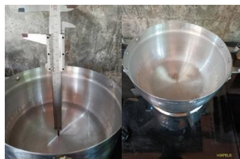
(ข) ภาพก่อนและหลังการทดลองของ หม้อใบที่ 2 ขนาดเส้นผ่านศูนย์กลาง 22 เซนติเมตรในปริมาณน้ำ 600 มิลลิลิตร
