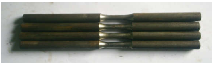
ภาพที่ 4 ชิ้นงานทดสอบเหล็ก St37 ตามมาตรฐาน JIS Z2274
