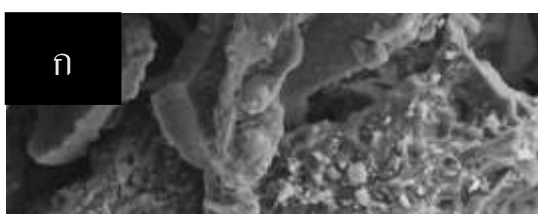
ภาพที่ 2 แสดงลักษณะทางกายภาพที่กำลังขยาย 5000 เท่าของเปลือกกล้วยน้ำหว้าที่เตรียมถ่านกัมมันต์โดยวิธีคาร์บอนเซชันและวิธีกระตุ้นทางเคมี เผาอุณหภูมิที่ 700°C เป็นเวลา 2 วิธีคาร์บอนเซชัน สเกลบาร์ (ก) ขั้วโคม โดย 2 ไมโครเมตร 1 วิธีกระตุ้นทางเคมี สเกลบาร์ (ข) ไมโครเมตร
