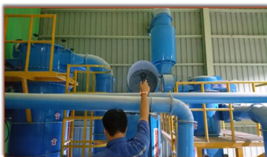
ภาพที่ 1 จุดที่ทำการวัดความเร็วลมจากปลายปล่องลมทิ้งของเครื่องดูดฝุ่นชนิดถุงกรอง ขนาด 50 แรงม้า
